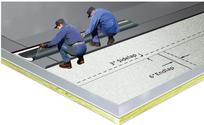
sivo de betún modificado TopShield® #33 de aplicación en tubo o a paleta en el borde del corte en ángulo para evitar que se genere un capilar. El uso de una pistola de aire caliente de mano en la junta antes de enrollar la membrana garantizará una máxima adherencia. Se recomienda aplicar una gota de adhesivo de betún modificado TopShield® #33 SBS de aplicación en tubo en todos los solapes laterales y finales de las capas SA PlyBase para evitar que se genere un capilar.
